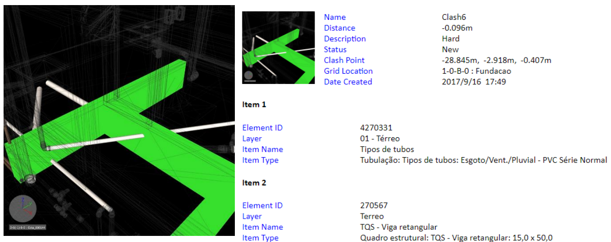
Figura 7: visualização de interferência entre elemento estrutural e hidráulico
